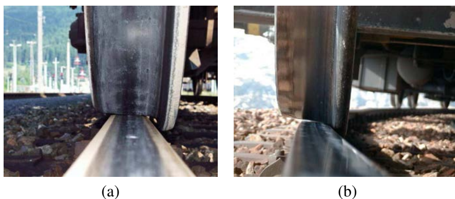
FIGURE 1.8: (a) Contact roue-rail entre la bande de roulement de la roue et la table de roulement du rail en alignement. (b) Contact roue-rail entre le boudin de la roue et le congé du rail en courbe.
