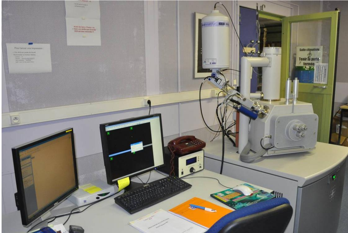
Fig. a5 FEI Quanta 600 SEM
