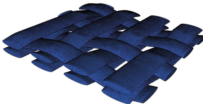
(b) Maillage EF volumique d'un renfort tissé [Cou08].
