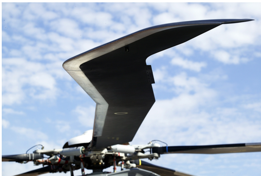
FIGURE 1.7: Pale BlueEdge™ dimensionnée pour l'hélicoptère EC155
