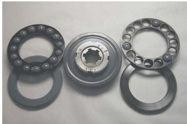
Figure II.28. Vue éclatée des différents constituants du montage de la butée FB2.
