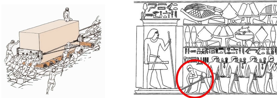
a) Remplacement du frottement de glissement par du frottement de roulement
