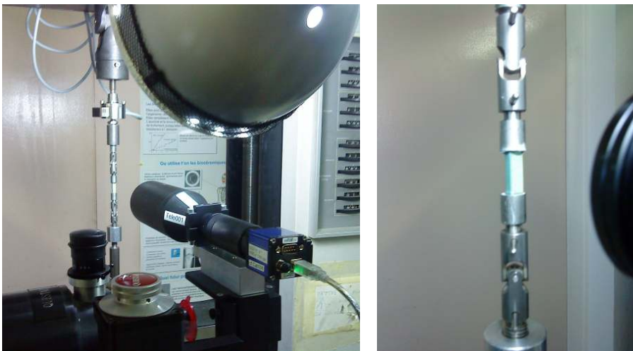
Figure 2.7: Montage pour les essais de traction à température ambiante avec corrélation d'images.
