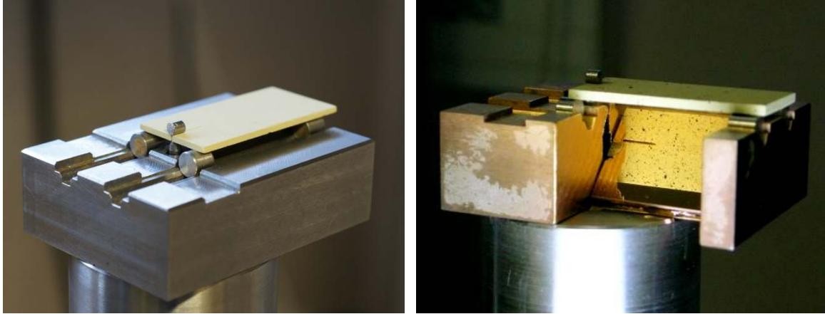
Figure 2.8: Montage de double-torsion à température ambiante, sans et avec corrélation d'images.
