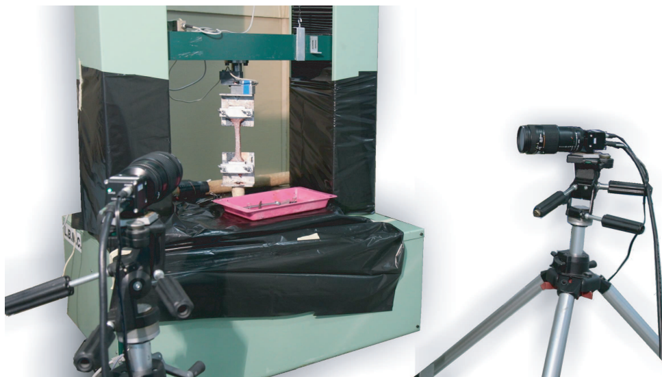
FIGURE 2.5: Montage expérimental du protocole de traction uniaxiale sur échantillons de capsule et parenchyme. L'échantillon et les mors forment un angle de 45^\circ avec la machine. Deux caméras enregistrent l'évolution de la face et de la tranche de l'échantillon respectivement.
