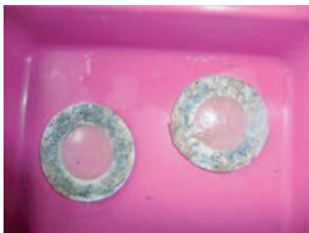
FIGURE A.1: Éprouvettes prélevées et disposées sur des joints en silicone
