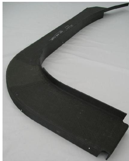
**Figure 1-9 : Préforme NCF et pièce composite finale pour NH90**
