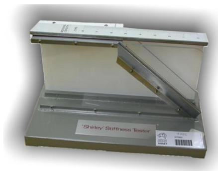
**Figure 3-10 : Flexomètre standard à plan incliné fixe**
