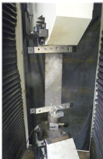
**Figure 3-12 : Machine de traction avec éprouvette de Bias-test**
