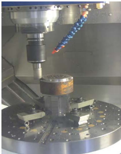
Figure 3.7 : Exemple d'opérations d'usinage sur le pignon
