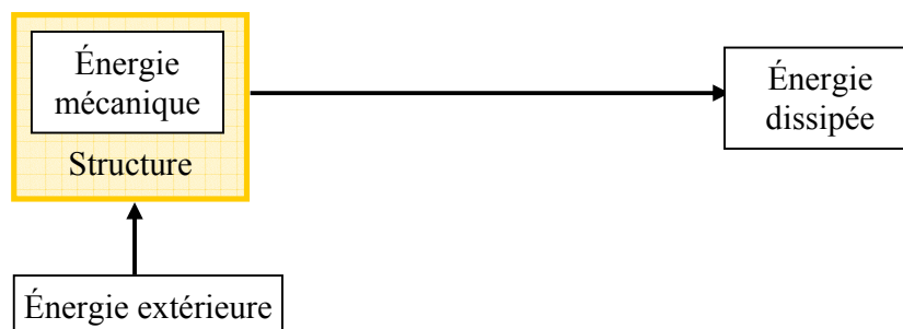
Figure 1.8 Conversion d'énergie du contrôle actif
