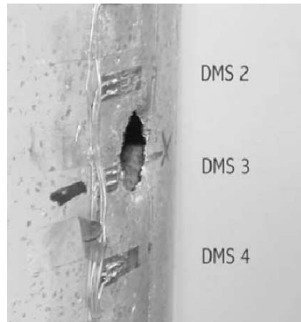
FIGURE 3.13: Faciès de rupture du cylindre vide [TIM 03].
