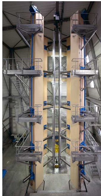
FIGURE 5.2: Tour de chute de l'ONERA de Lille.
