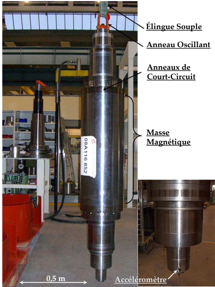
FIGURE 4.15 – Dispositif expérimental employé lors de l'analyse modale.
