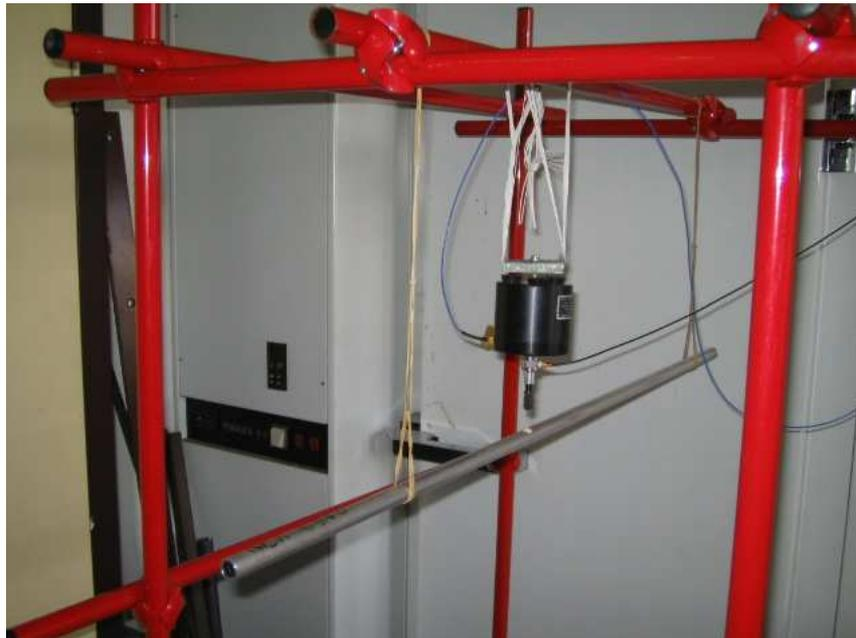
**FIG. 3.19:** Caractérisation expérimentale de l'amortissement interne d'un arbre Aluminium
