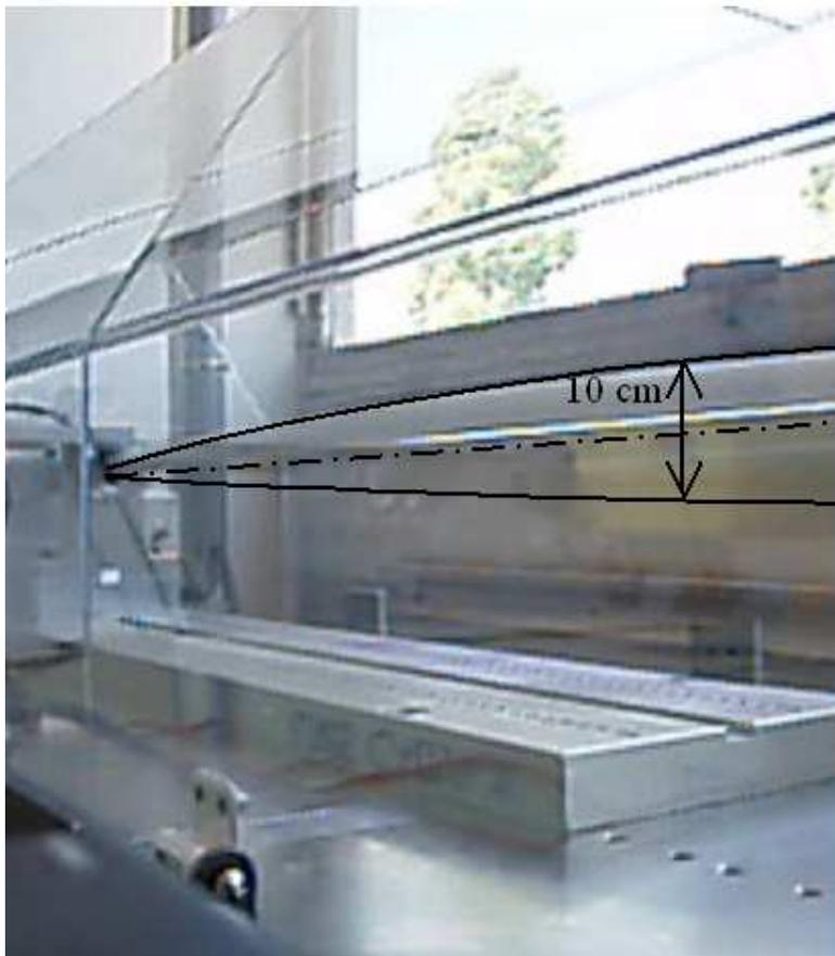
**FIG. 3.29:** Déplacement pendant une montée en vitesse
