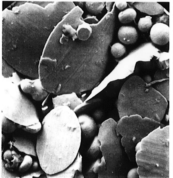
**Figure 93 - Forme des particules après leur passage dans les contacts glissants**
