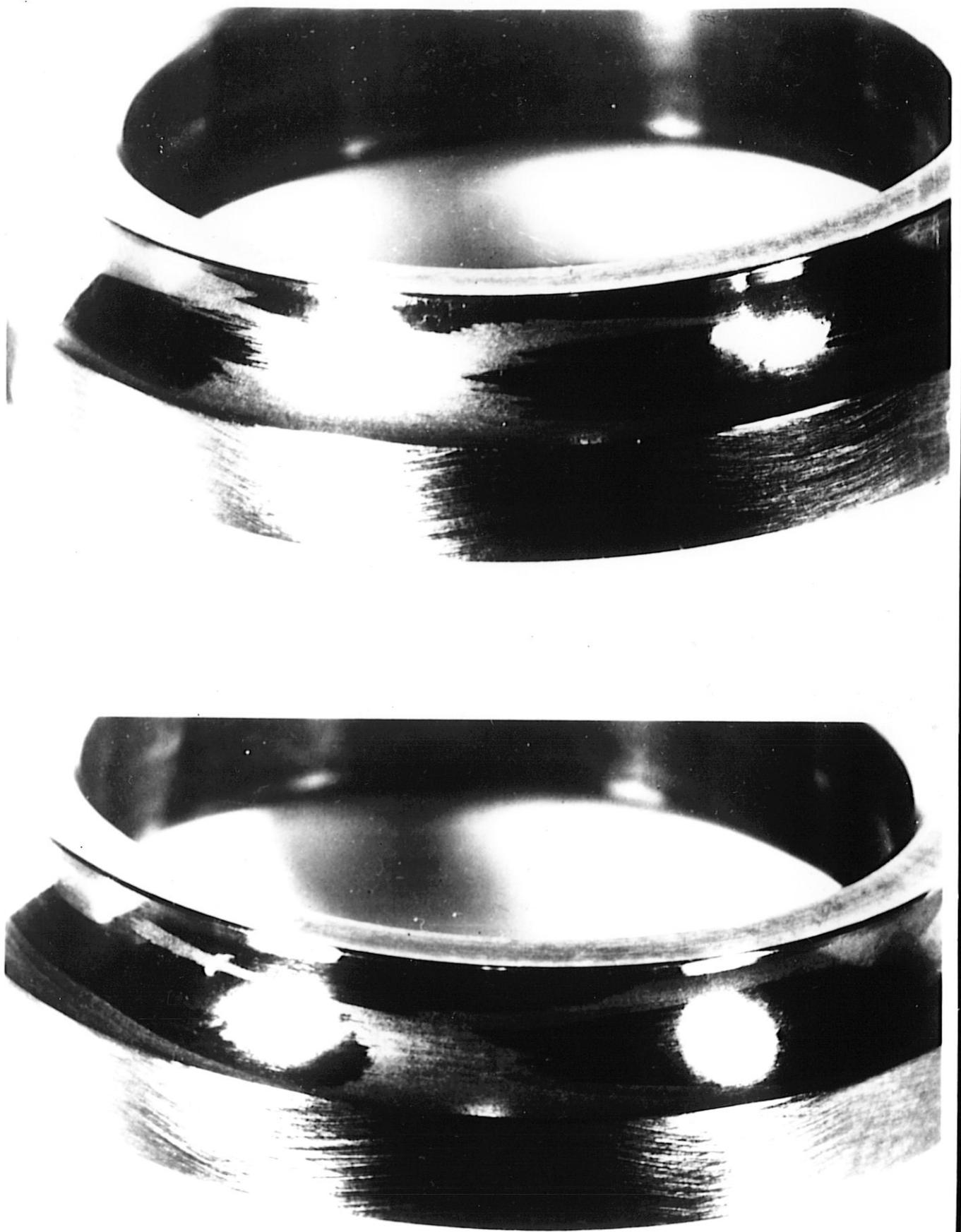
Figure 85a - Détériorations par glissement
