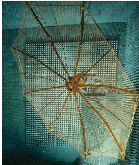
FIG. 1.12 – Réflecteur de 5m déployé par huit mâts CTM
