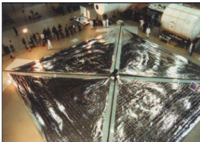
FIG. 1.11 – Voile solaire (20 m x 20 m) déployée par quatre mâts CTM
