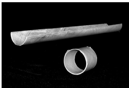
FIG. 1.8 – Lamé déployée et enroulée en composite bi-stable
