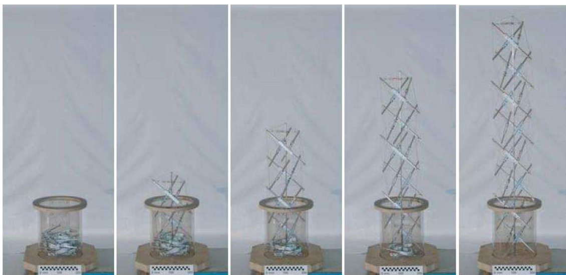
FIG. 1.16 – Séquence de déploiement d'un mât de huit étages
