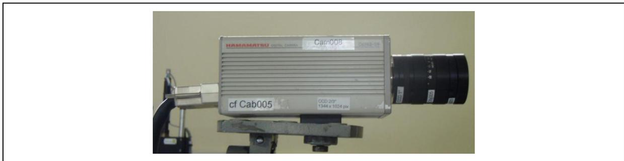
Figure A-4 : Caméra Hamamatsu 1344 x 1024 pixels et objectif Fujinon TV Lens 1:1.4/16mm
