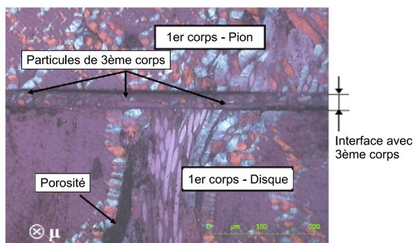
FIG. 1.3: Mise en évidence de la présence d'un troisième corps dans le contact carbone-carbone réalisé dans le cas du frottement pion-disque [28].
