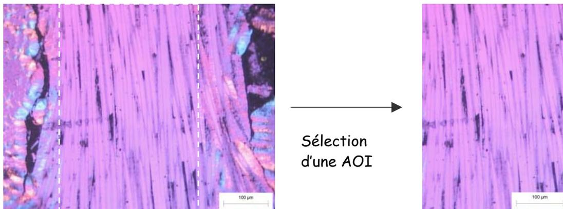
**Figure 149.** Exemple de sélection d'une surface répondant aux critères souhaités (fibres longitudinales, perpendiculaires aux rayures).
