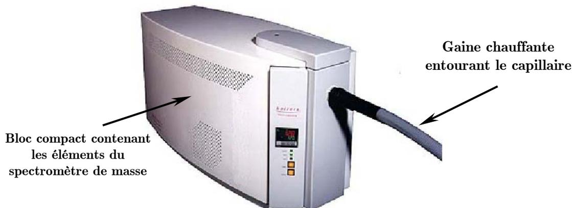
Figure 50. Photo du spectromètre de masse utilisé
