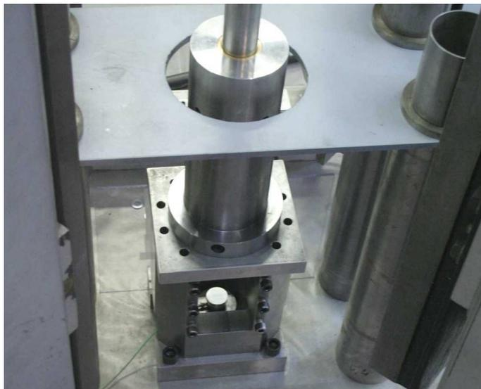
**FIG. 4.3:** *Eprouvette en situation fixée au cylindre et au support*
