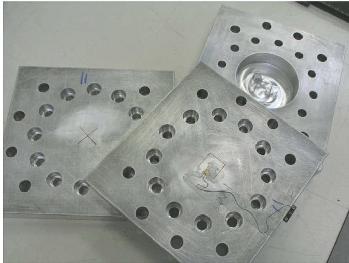
**FIG. 4.2:** *Eprouvettes munies d'entailles en X (vue du coté inférieur) et en U (coté inférieur et supérieur)*
