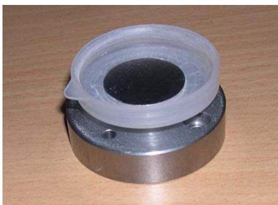
*Figure 42 : Eprouvette inférieure munie d'une coupelle de récupération des particules éjectées.*
