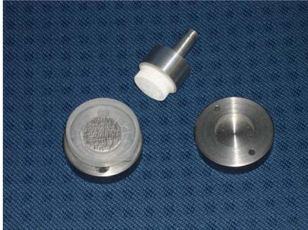
*Figure 43 : Une éprouvette supérieure usagée (en haut), et les deux éprouvettes inférieures, pour contact ouvert( à gauche) et contact fermé (à droite).*
