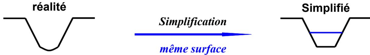
Figure 9-5 : Simplification de la géométrie du chanfrein
