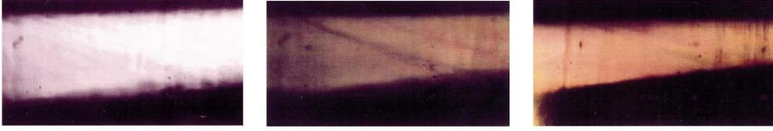
Fig. 2.1 : Bandes de cisaillement entre deux plans convergeant et en glissement relatif, la surface inclinée du bas étant stationnaire. Le lubrifiant utilisé est du 5P4E sous une pression de 1398 MPa et une température de 5 °C [BAIR1998].
