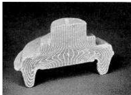
Fig. 1.3 : Exemple de maquette de lopin en cire [AVITZUR1992].
