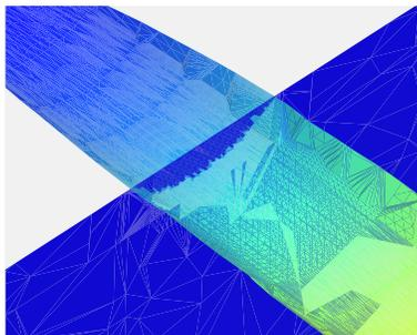
FIG. 4.16 – Représentation des fissures par les isovaleurs des fonctions de niveaux
