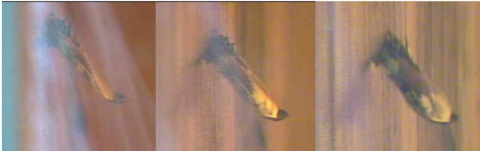
FIG. 1.15 – Illustration de la géométrie tridimensionnelle d'une fissure propagée avec un lubrifiant
