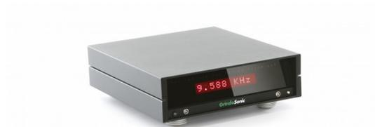
**(a)** Système de mesure de vibration *GrindoSonic MK6-Advanced*
