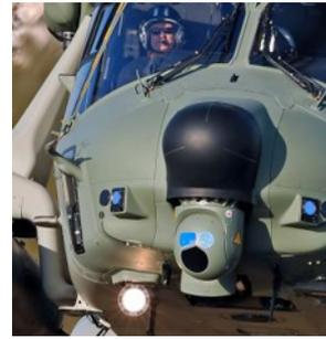
**FIGURE 4** – Boule optronique aéroportée d'observation et de surveillance *Safran Electronics & Defense* équipée d'une fenêtre IR
