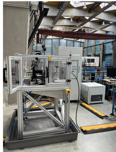
FIGURE 2.3 – Banc d'essai PJET fabriqué
