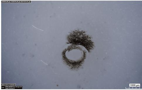
(a) Dommage *très important* 25 dû à 100 impacts à  $128 \text{ m s}^{-1}$  (éclairage coaxial, grossissement  $35\times$ )
