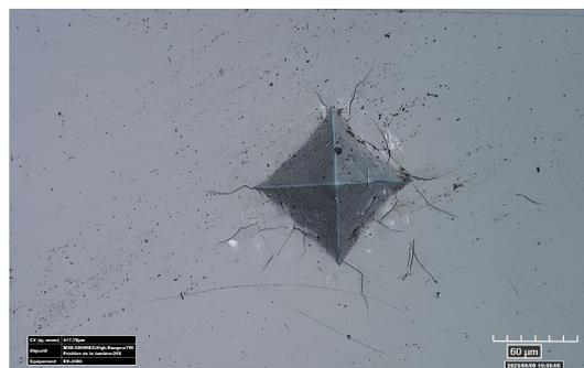
**FIGURE 2.29** – Indentation Vickers n°2 de l'échantillon n°3 à 1 kgf
