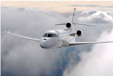
**FIGURE 5** – Falcon 8X (*Dassault Aviation*) équipé d'un système EFVS avec une fenêtre IR
