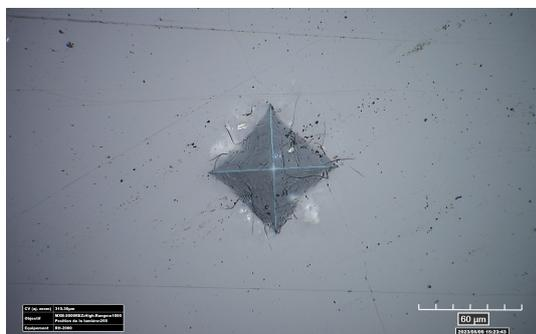
**FIGURE 2.28** – Indentation Vickers n°6 de l'échantillon n°3 à 0.5 kgf
