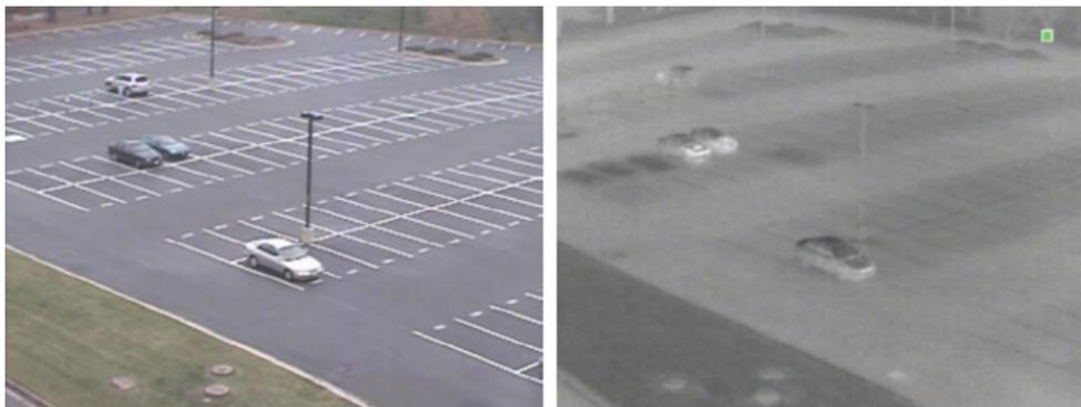
**FIGURE 2** – Comparaison d'une image dans le spectre visible (gauche) et dans le spectre **LWIR** (droite)
