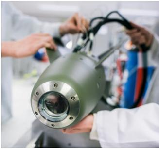
**FIGURE 3** – Autodirecteur *Safran Electronics & Defense* équipé d'un dôme IR
