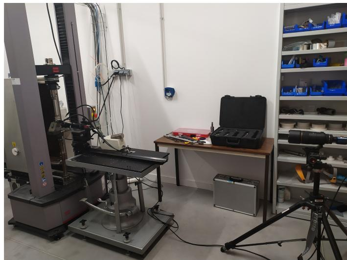
FIGURE 2.22 – Dispositif expérimental utilisé lors des essais de flexion
