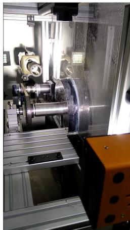
**FIGURE 4.1** – Montage utilisé pour la caractérisation par caméra rapide des jets produits par le banc d'essai (caméra rapide *Phantom V710* et ses accessoires ([Annexe A.6.1](#)))
