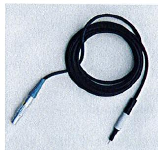
**(b)** Capteur piézoélectrique de mesure du *GrindoSonic MK6-Advanced*
