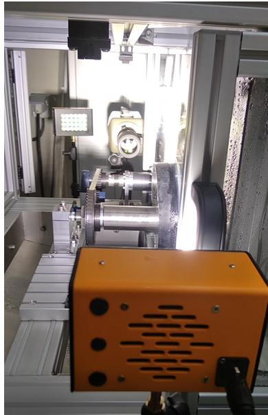
**FIGURE A.18** – Montage utilisé pour la visualisation des jets sur PJET
