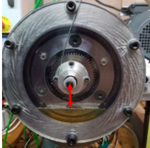
Figure II.6 – Définition du niveau du bain d’huile statique (flèche rouge)
