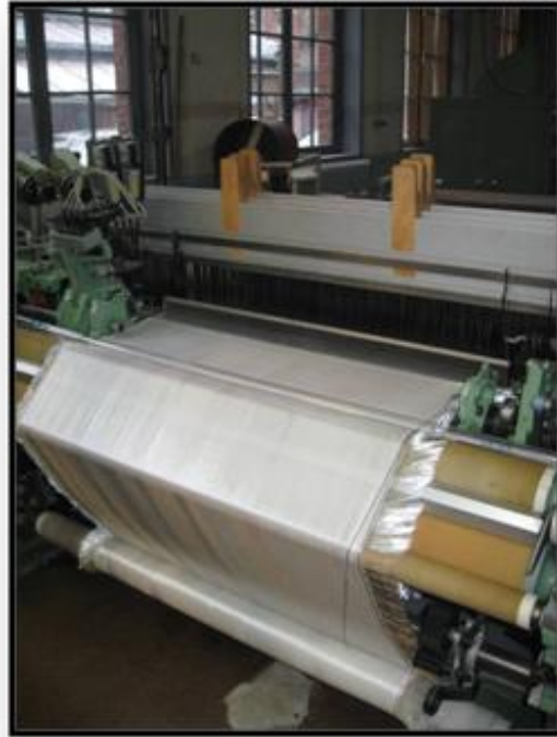
Figure 5-1. Production de tissus en verre à l'atelier tissage de l'ENSAIT, sur une machine à tisser Dornier.
