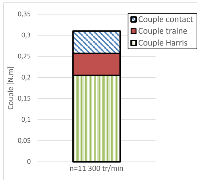
Figure 72: Première estimation de la répartition des pertes au sein du palier à roulement pour un fonctionnement hautes vitesses cas (X= 22%)
