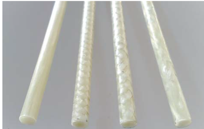
FIGURE 1.24 – Tubes tressés composites mis en oeuvre par pultrusion [AHM 09]
