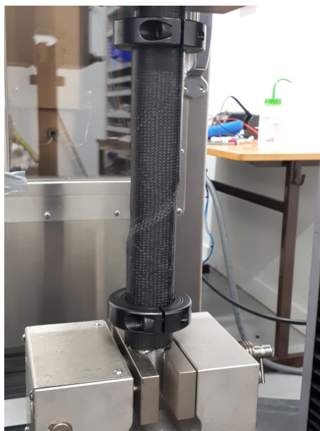
FIGURE 3.27 – Faciès de rupture d'un tube composite d'angle de tressage de 55 degrés
