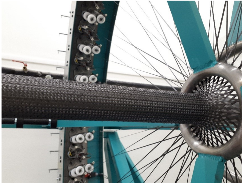
FIGURE 2.13 – Tressage d’un tube en fibre de carbone
