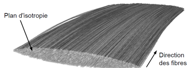
FIGURE 4.5 – Isotropie transverse de la mèche de renfort tissé. Image tomographique
