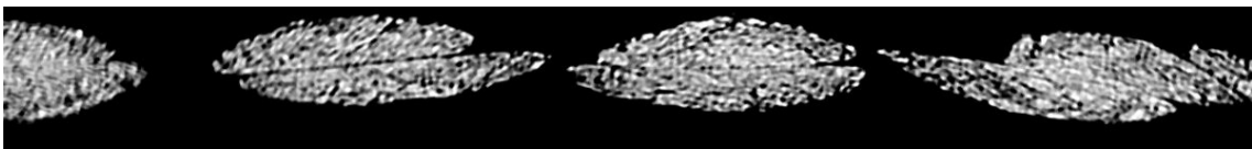
FIGURE 5.6 – Coupe de l'échantillon tressé dans le plan (yz)
