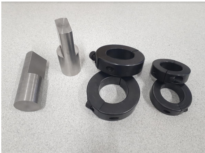
FIGURE 2.22 – Tenons usinés et bagues de serrage
