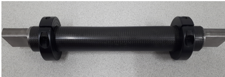
FIGURE 3.25 – Tube en composite avec tenons pour essai de traction
