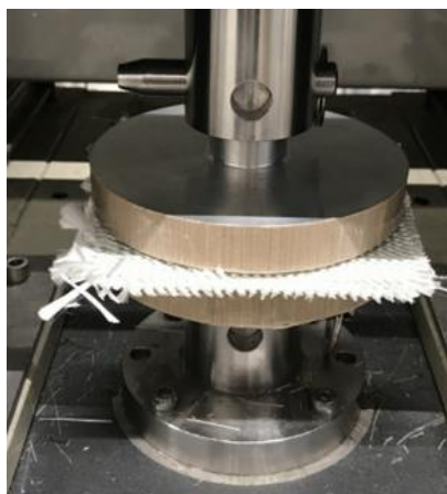
Figure 1-23 Essai de compression transverse sur un renfort interlock (Interlock-II)
