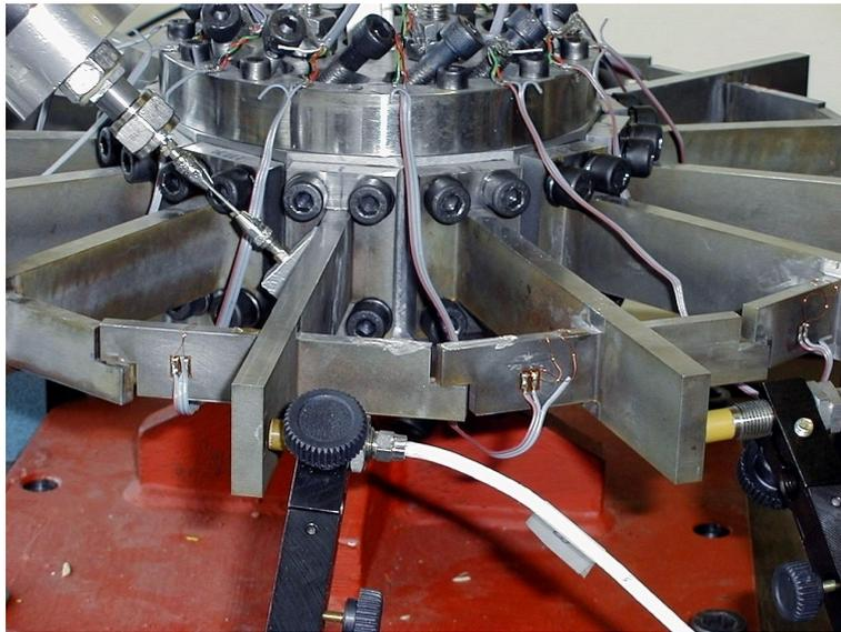
FIG. 3.1 Système instrumenté de deux aubes mises en contact
