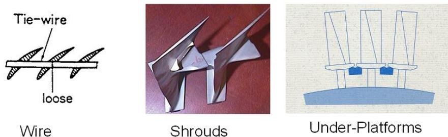
FIG. 1 Différents types de limiteurs de pics utilisés dans l'industrie
