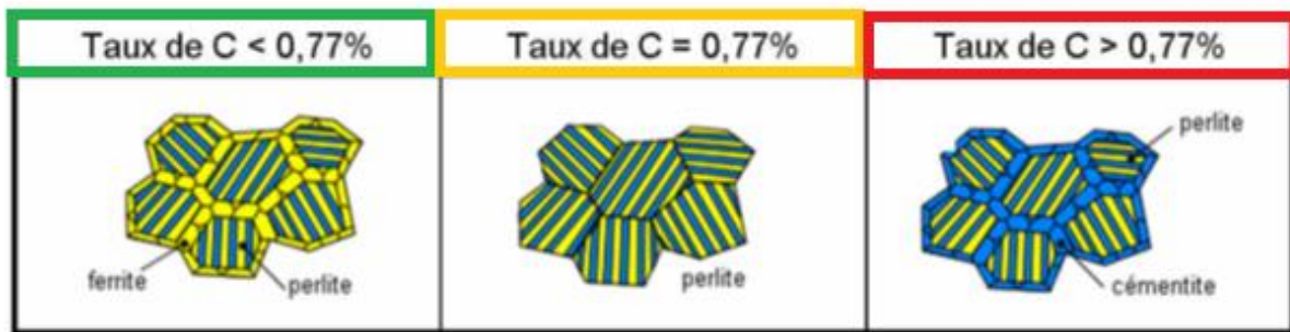
Figure 13 Structure granulaire de la perlite hypoeutectoïde, eutectoïde et hypereutectoïde (Simon, 2014)
