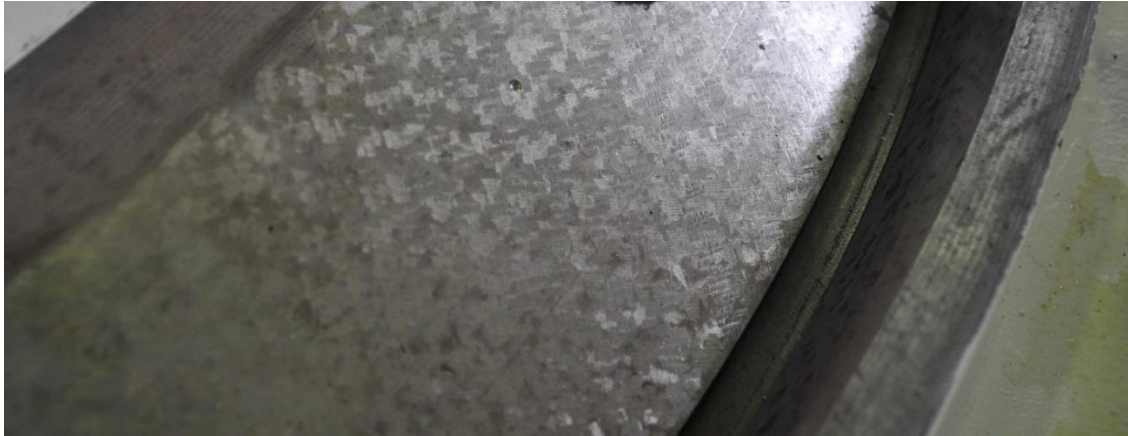
Figure 140 Cupules permettant l'écoulement de l'huile au niveau de la gorge en V
