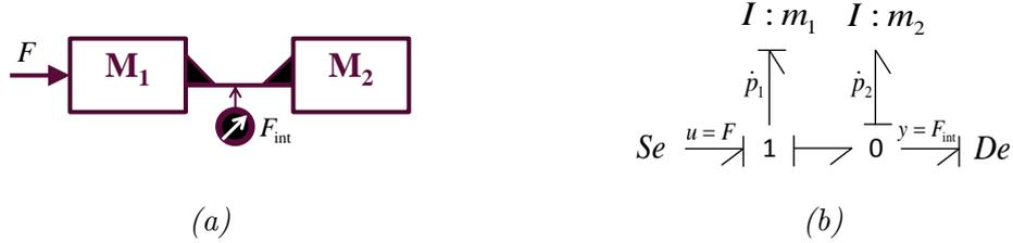
FIGURE 5.2 – Exemple de deux masses en liaison encastrement
