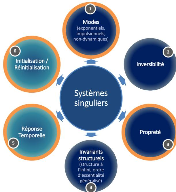
FIGURE 5.1 – Spécificités et propriétés des systèmes singuliers : le [chapitre 5](#) aborde les items 5 et 6 du point de vue algébrique et les items 1, 3, 5 et 6 du point de vue bond graph
