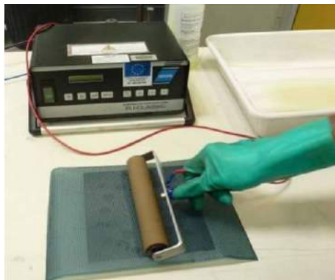
(a) Electro-marquage face extérieure (stencil avec matrice de points de 1mm).
