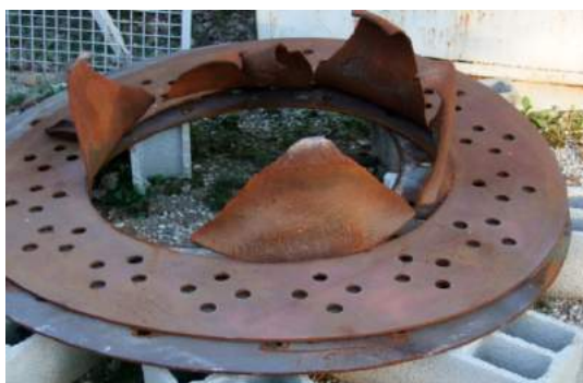
(a) Multifissuration avec formation de pétales.
