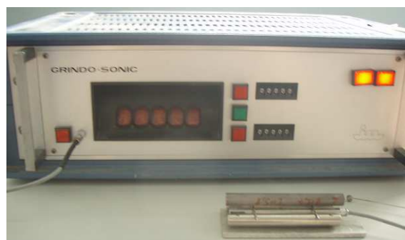
FIGURE B.1 – Dispositif expérimental de mesure du module de Young par la méthode des fréquences propres
