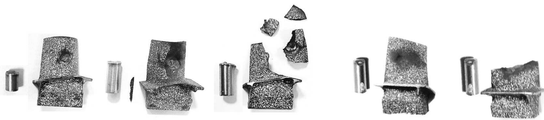
FIGURE 3.37 – Différents faciès de pales après impact
