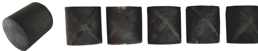
FIGURE 2.9 – Allure de plots en MC2 après essais de compression dynamique. Les lignes distinctement observables sur les échantillons correspondent à l'activation de réseaux de plans de glissement.
