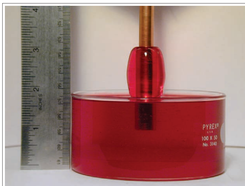
FIGURE I.15 – Effet Weissenberg : Ascension d'un fluide sur une tige [source : MIT]
