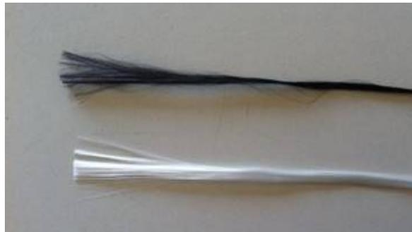
*Figure 2: Mèches de fibres longues (carbone et verre)*
