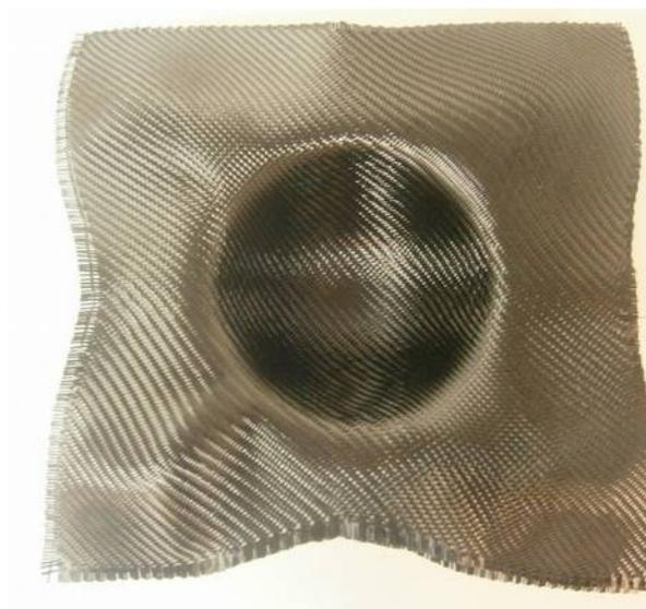
**Figure 104:** *Hémisphère réalisé avec des tissus secs*
