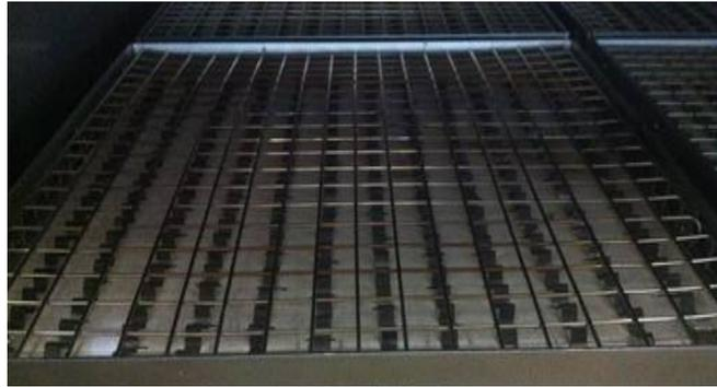
**Figure 17:** Lampes infrarouges à lames rayonnantes
