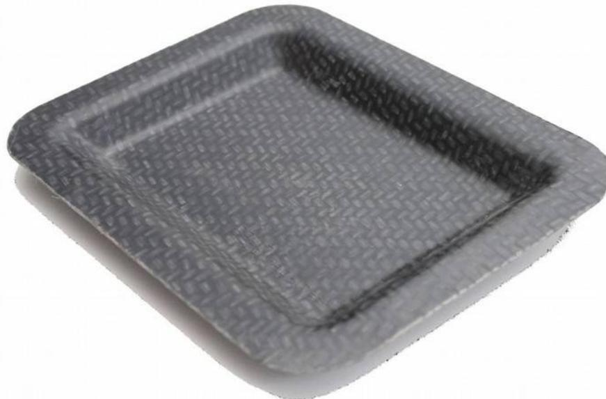
*Figure 8: Plateau réalisé par thermo-estampage*
