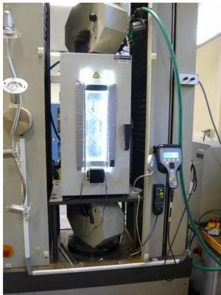
*Figure 136: Bias-extension test en température*
