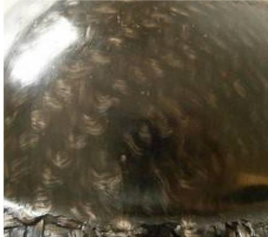
*Figure 43: Flambement local des mèches transverses*
