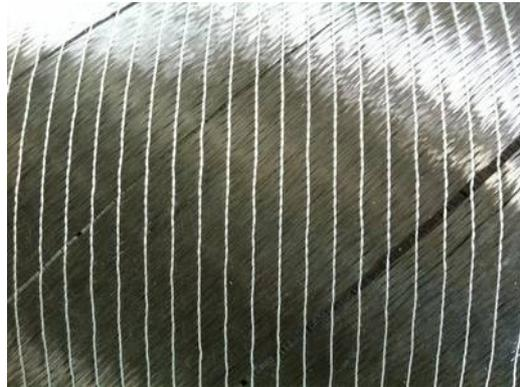
*Figure 4: Illustration d'un N.C.F.*
