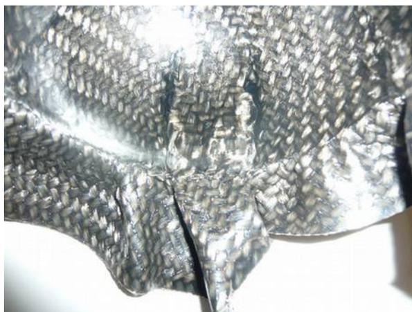
*Figure 42: Exemple de plis à l'intérieur d'un hémisphère*
