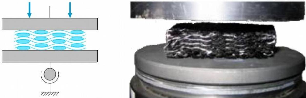
*Figure 73: Essai de compression transverse sur tissu épais [ORL 2012]*
