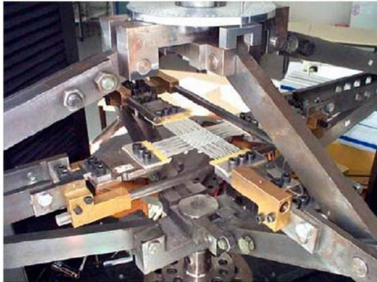
*Figure 68: Dispositif pour essai de traction biaxiale* [BUE 1998]
