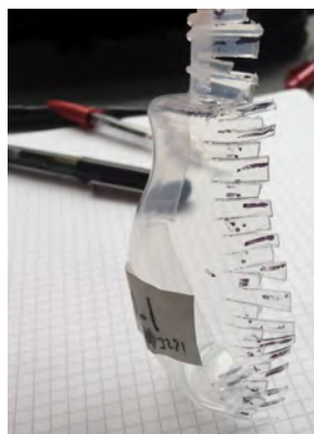
FIGURE 2.39 – Photo d'un flacon en PPR3221 après prélèvement des échantillons
