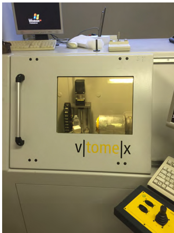
FIGURE 3.43 – Une moitié de flacon dans l’enceinte du tomographe
