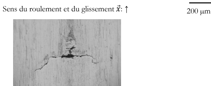
Fig 4-8. Micro-écaille de l'essai E05 très fine et sans arrachement important de matière, qui a évolué vers les prémices de l'écailage.
