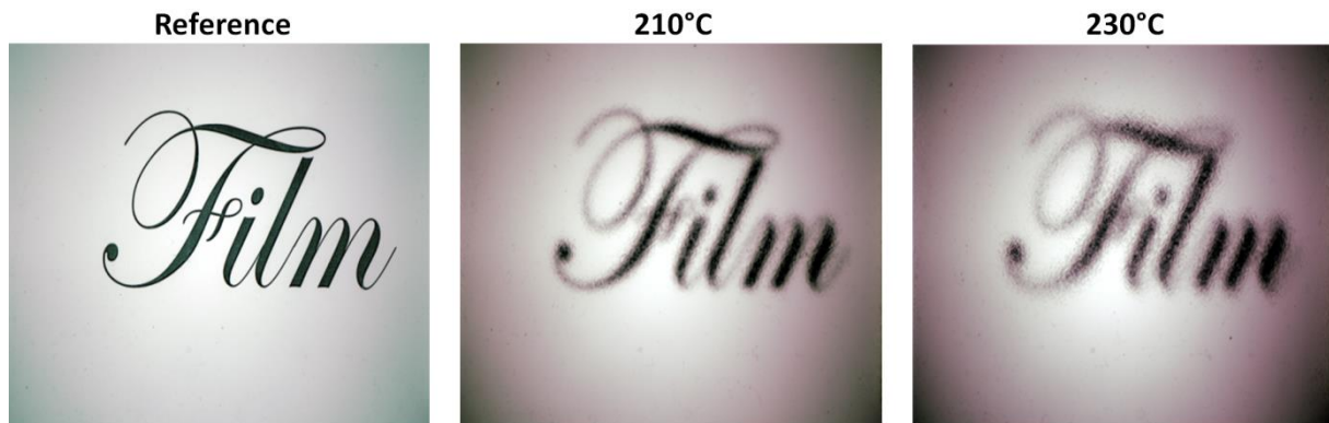
Figure 92 Photographies montrant l'aspect de films multicouches PP/L0/EVOH32/L0/PP à 210°C et 230°C
