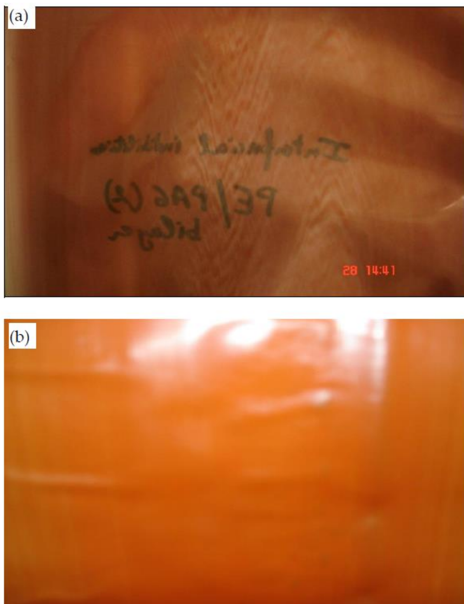
Figure 12 Photographies de films coextrudés : (a) instabilités dans un bicouche PA6/PE et (b) un bicouche stable PE-g-GMA/PA6 obtenus à 240°C et un ratio de débit égal à 1 (les polymères colorés en rouge sont le PE et le PE-g-GMA) [25]
