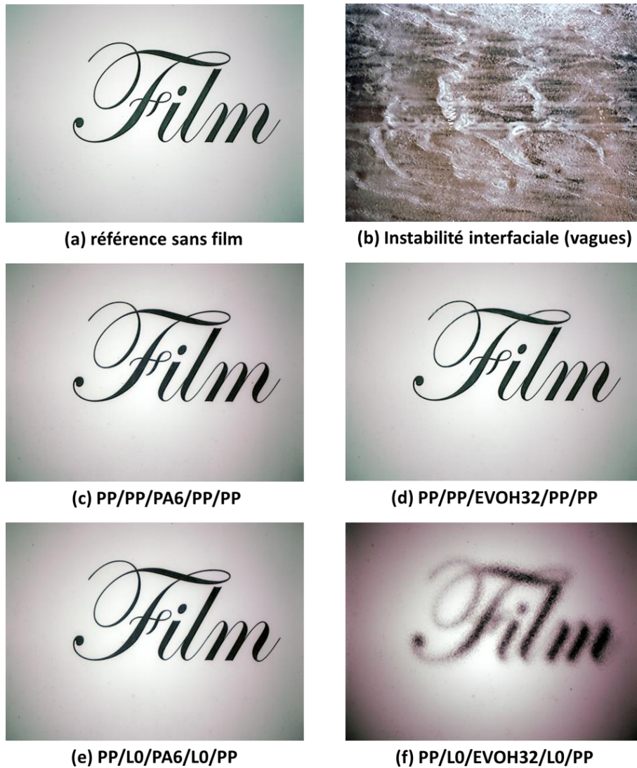
Figure 83 Photographies des films multicouches réactifs et non réactifs comprenant le PA6 ou l'EVOH32 – visualisation de la transparence des films en présence de défauts et des instabilités de type vagues
