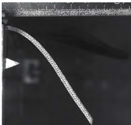
FIGURE 2.17 – Flexion à chaud d'un préconsolidé
