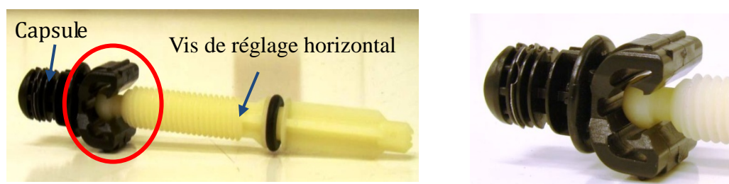
Figure 2-16 : Liaison de type linéaire annulaire
