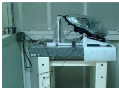
Figure 3-17 : Essai d'analyse modale avec réponse impulsionnelle sur un projecteur complet
