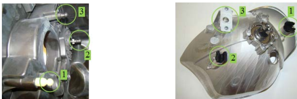
Figure 2-2 : Photos des liaisons entre le boîtier (à gauche) et le réflecteur (à droite)
