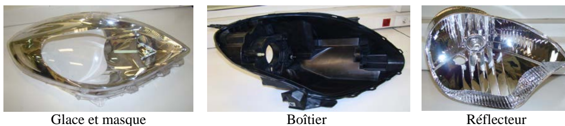
Figure 2-1 : Eléments principaux du projecteur testé
