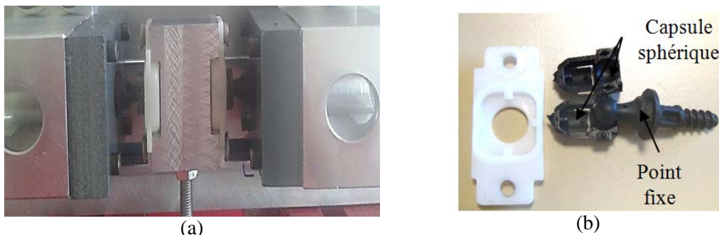
Figure 2-38 : Dispositif utilisé pour les essais de caractérisation ; (a) vue générale du montage 3 fixé sur le pot vibrant, (b) vue éclatée de la liaison capsule sphérique et la rotule du point fixe
