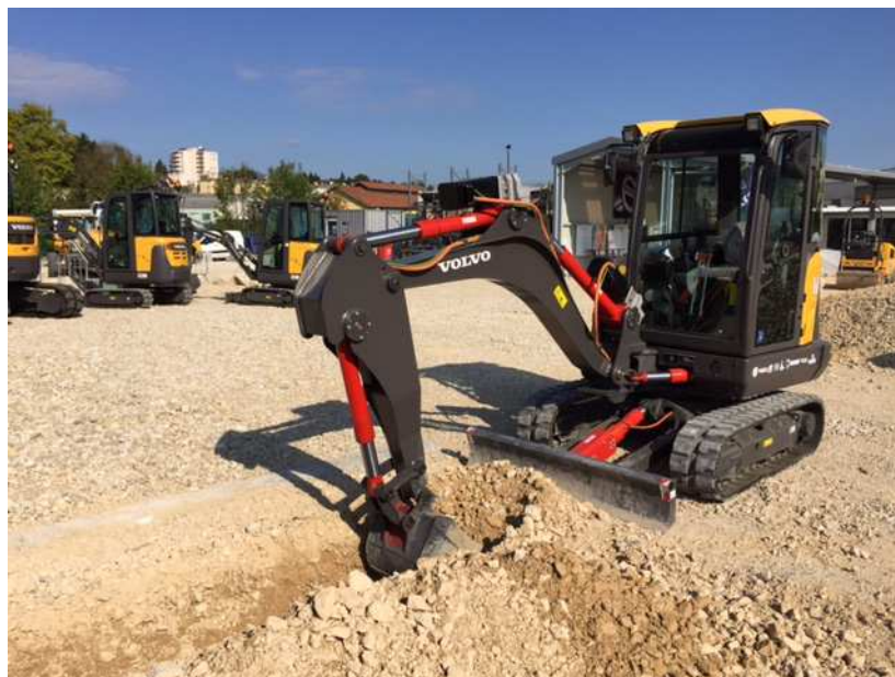
FIGURE 2: Mini excavatrice 100% électrique.
