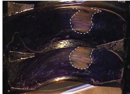
**Figure I.41 : Photo d'une dent de la roue issue d'un essai d'endurance [121]**
