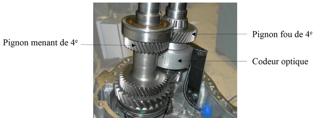
**FIGURE 4.1:** Instrumentation interne de la boîte de vitesses.
