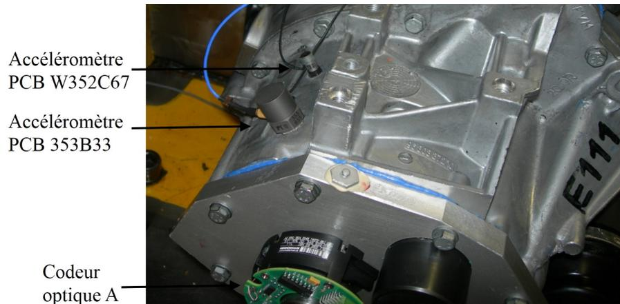
**FIGURE A.8:** Observation de la face supérieure de la boîte de vitesses instrumentée.
