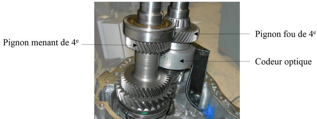
FIGURE A.6: Instrumentation interne de la boîte de vitesses.
