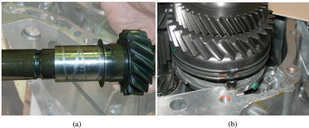
**FIGURE 4.2:** Instrumentation interne de la boîte de vitesses. (a) Vue de la bague et de ses gorges placée entre l'arbre et le codeur. (b) Blocage par soudure du 2<sup>e</sup> rapport engagé.
