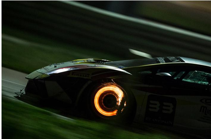
**Figure 1.1:** échauffement notoire lors du freinage d'une Lamborghini Gallardo<sup>1</sup>.
