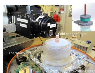
Essai de solidification in situ d'un gel aqueux de nanocristaux de cellulose (CNC) à une concentration massique de 8.8%
