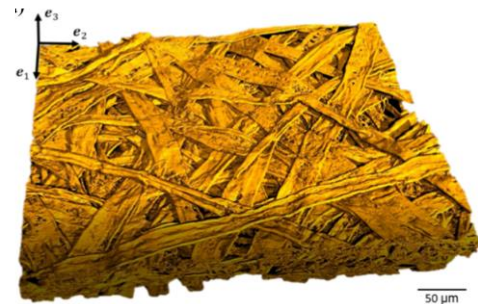
Fig. 1. Structure 3D du réseau fibreux d'un papier obtenue par microtomographie à rayons X.
