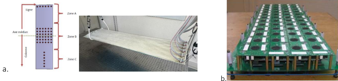
Figure 1 : Smart structure à réseau de transducteur a) Spoiler- Smart composite, b) active skin.
