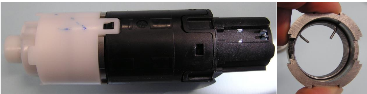
Figure 1. A. Visualisation d'un réducteur de moteur tubulaire composé de plusieurs étages de réduction et d'un frein mécanique à ressort ; B. Détail d'un frein à ressort (ressort contenu dans un tambour)
